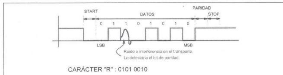
Figura 1.1.13 Detección de un error en el bit de paridad.
