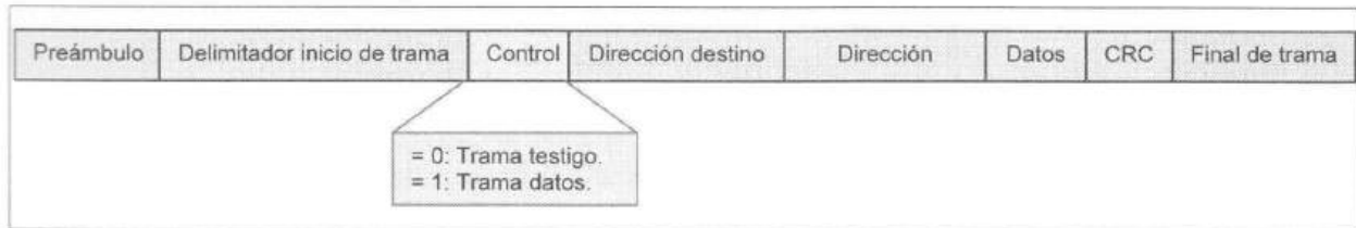
Figura 1.6.2 Campos de la trama de paso de testigo.
